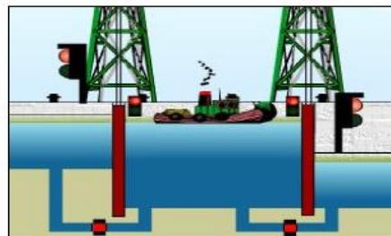
4. L'ouverture de la vanne permet d'amener le bateau au même niveau d'eau qu'en aval. La porte est alors ouverte.
